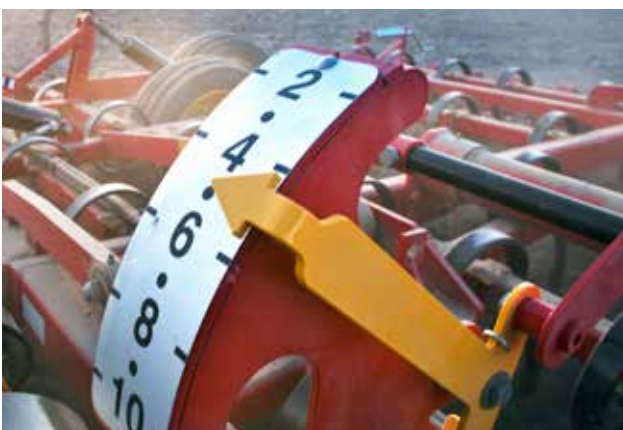
Die ControlFunction an der NZ Aggressive ermöglicht die Verstellung der Arbeitstiefe an wechselnde Bodenverhältnisse während der Fahrt.
