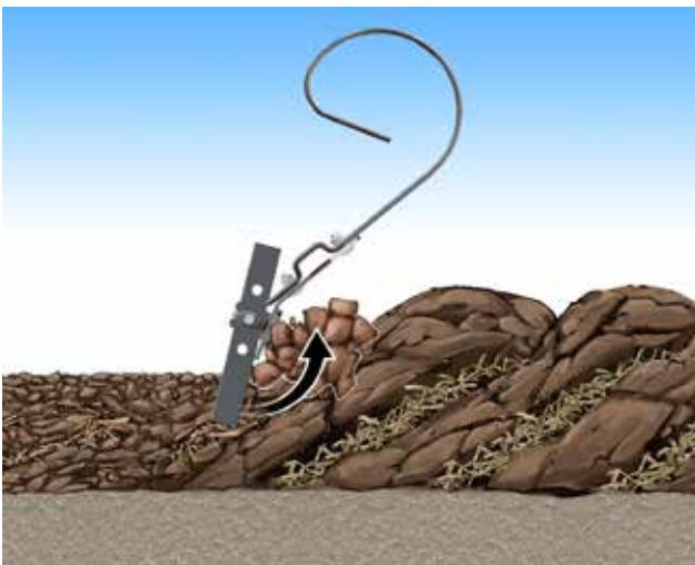
Zusätzlich zur Furchenbrechung füttert SingleKnife das CrossBoard mit mehr Material und verstärkt somit die Erzeugung von Feinerde.
