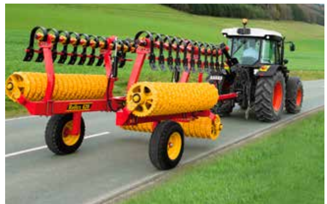
Um einen bequemen Transport zwischen den Feldern zu ermöglichen klappt Rollex auf 2,8 Meter Transportbreite.
