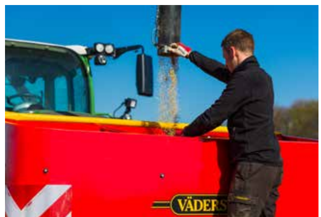
Das abfallende Tankdesign gibt dem Fahrer eine gute Sicht nach vorne. Die breite Öffnung und die eingebaute Trittstufe erleichtern die Befüllung.
