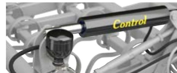
Ein Akkumulator reduziert die Stöße, die während des Transports auf den Rahmen einwirken. Dies erhöht die Lebensdauer des Rahmens bei hohen Transportgeschwindigkeiten erheblich. Der Praxistest zeigt eine 50 %-ige Reduzierung der Kräfte auf Achsen und Radnaben beim Transport. Control-Funktion erforderlich.
