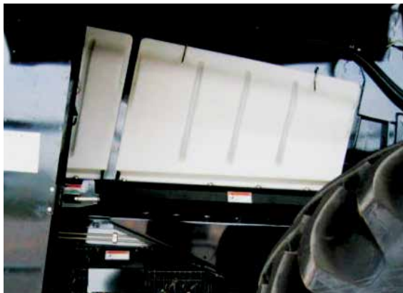
Hervorragende Zugänglichkeit für Reinigungs- und Wartungsarbeiten von der linken und rechten Seite durch Entfernen der weißen Kunststoffformteile.
