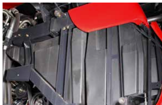
Kraftstofftankvolumen von 1.125 Litern (7250, 8250) bzw. 1.200 Litern (9250) für lange Arbeitstage. Bei Ausstattung mit X-tra Chopping Strohhäcksler hat das Modell 9250 ein Kraftstofftankvolumen von 1.020 Litern.
