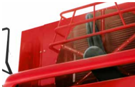
Fest montierter Kühlergrill für optimale Staubentfernung.
