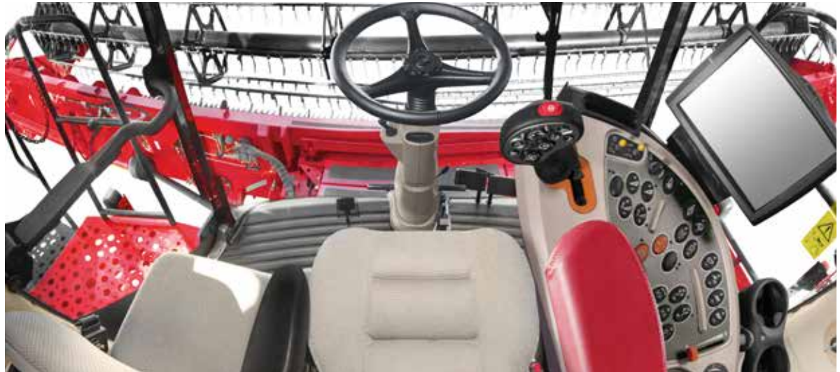
Komfortable Kabine, volle Sicht auf das Schneidwerk und ergonomisch angeordnete Bedienkonsole.
