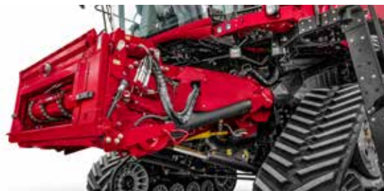
Steuerung des Schneidwerk-Anstellwinkels – schnelle Verstellung aus der Kabine und Anpassung an alle Situationen.
