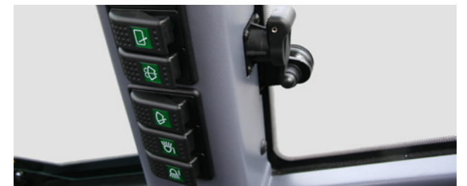
Zusammengefasste Schalterleiste, Steckdose mit Dauerstrom
