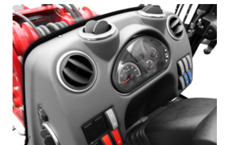
Zusätzliche, größere Luftauslässe für optimale Luftzirkulation / optimierte Schalterbaureihe
