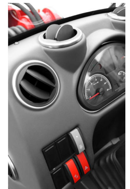
Zusätzliche, größere Luftauslässe für optimale Luftzirkulation / optimierte Schalterbaureihe
