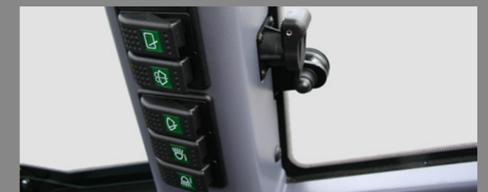
Zusammengefasste Schalterleiste, Steckdose mit Dauerstrom
