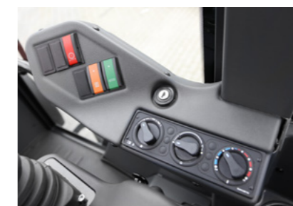
Neue Konsole: Zündschloss, Regler für Heizung und optionale Klimaanlage sind leicht zu erreichen.
