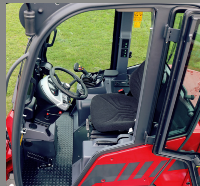
Zusammengefasste Schalterleiste, Steckdose mit Dauerstrom
