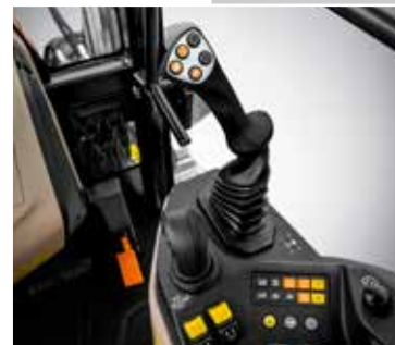
OPTIONALER JOYSTICK FÜR EINE PRÄZISE STEUERUNG DER ZWISCHENACHSANSCHLÜSSE
