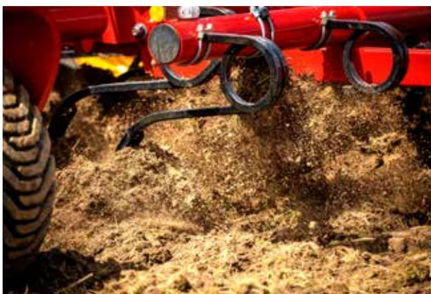
*Die vibrierenden Swift-Zinken sorgen für eine intensive Durchmischung bis zu einer Arbeitstiefe von 20 cm.*
