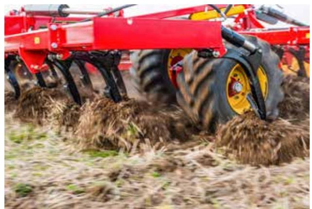
Die kraftvollen Opus-Zinken sind mit einer Steinsicherung mit bis zu 700 kg Auslösekraft ausgestattet. Dadurch wird die Arbeitstiefe auf bis zu 40 cm zuverlässig eingehalten.
