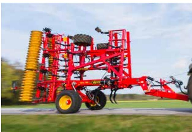
Die in der Mitte der Maschine angeordneten Transporträder erleichtern den Transport und ermöglichen dem Opus einen engen Wenderadius am Vorgewende.
