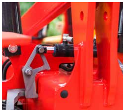
Die Carrier XT lässt sich leicht von der Kabine aus steuern, einschließlich der hydraulischen Flügelentriegelung.
