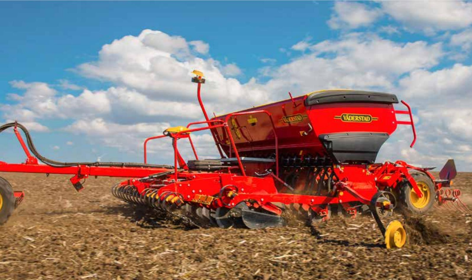
Dank ihrer Vielseitigkeit ist die Maschine in der Lage, mehrere Kulturen, Grassamen, Zwischenfrüchte sowie Mikrogranulate oder Schneckenkorn gleichzeitig auszubringen. Ausgestattet mit der aufsattelbaren Kleinsämaschine BioDrill kann eine zusätzliche Kultur hinzugefügt werden.
