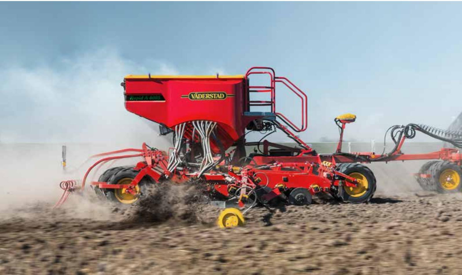
Die drei Drillmaschinen der Produktfamilie sind reine Sämaschinen, die mit einem hochpräzisen Dosiersystem ausgestattet sind.
