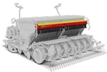
*Rapid 300-400C/S kann mit BioDrill 180-250 ausgestattet werden. Sie verfügt über ein Dosiersystem mit wenigen beweglichen Teilen, was zu minimaler Wartung und langer Lebensdauer führt.*
