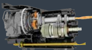
Stufenloses Getriebe von 0 bis 50 km/h
