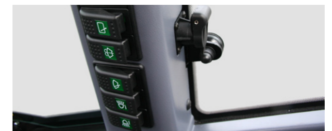
Zusammengefasste Schalterleiste, Steckdose mit Dauerstrom
