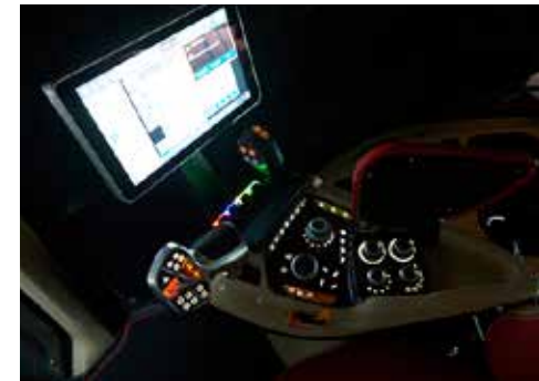
Die Symbole aller Schalter sind bei eingeschaltetem Fahrlicht hinterleuchtet.
