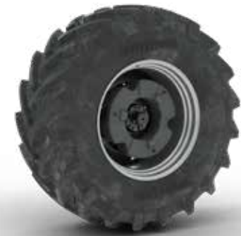
Insgesamt können bis zu 2.500 kg Hinterradgewichte montiert werden.
