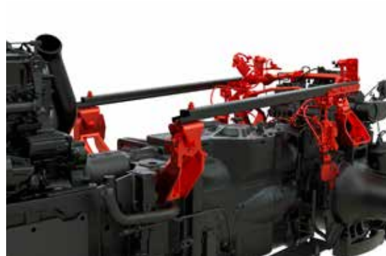
Die semi-aktive hydraulische Kabinenfederung absorbiert zuverlässig Stöße und Schwingungen.
